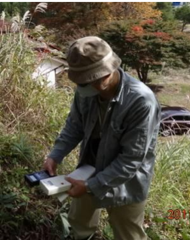
斜面で地表1メートルの放射線量を測定した
