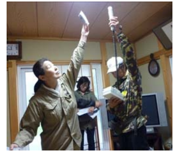
天井付近の空間線量率を測定
