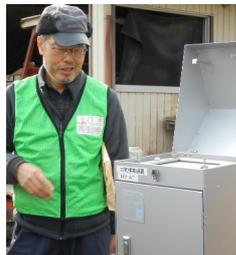
独自に開発した大気捕集装置で大気中のチリの放射線を測定している。
