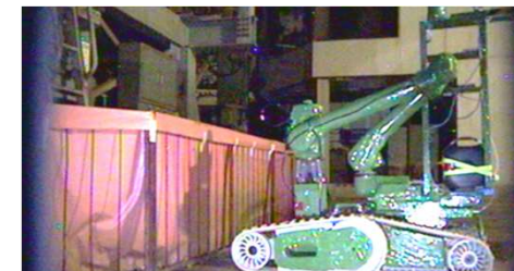
遠隔無人ロボットによる2号機オペフロ内の床面線量測定 (東京電力動画・写真ライブラリーより)
