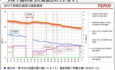
■ 軸方向・周方向の設置位置の違いによって、温度挙動に明確な違いはなかった。■ RPV底部に比較的近い、RPV下部周辺エリアに設置されている、RPV支持スカート部やCRDハウジング上端などの温度挙動は、RPV底部温度と概ね同等の推移を示していた。
