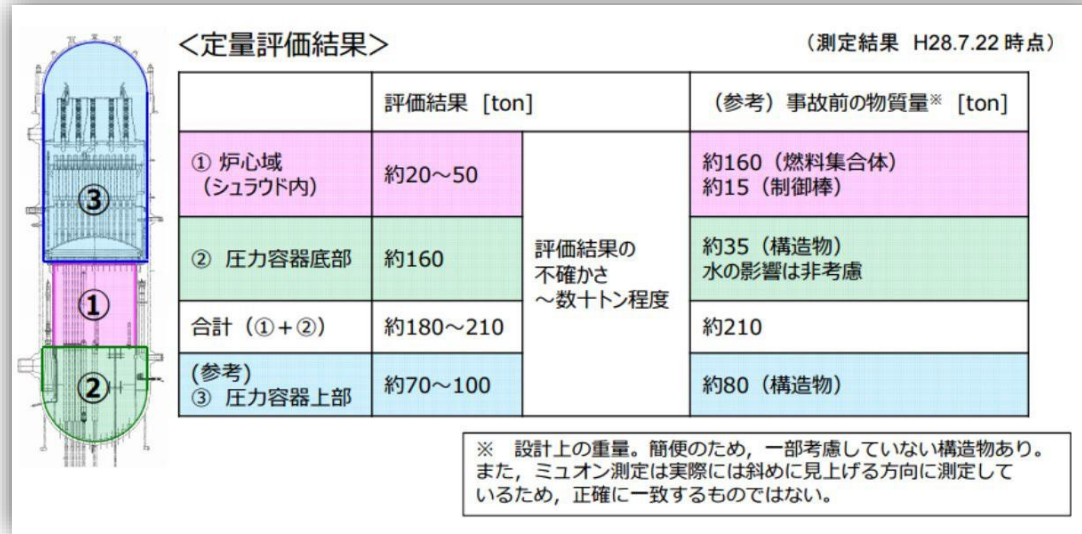
(2号機ミュオン透過法測定の結果から推定される核燃料デブリ分布(イメージ))
