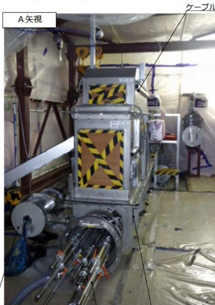
手動ドラム (インストール装置カメラ・水圧チューブ用) 操作用ポール シールボックス
