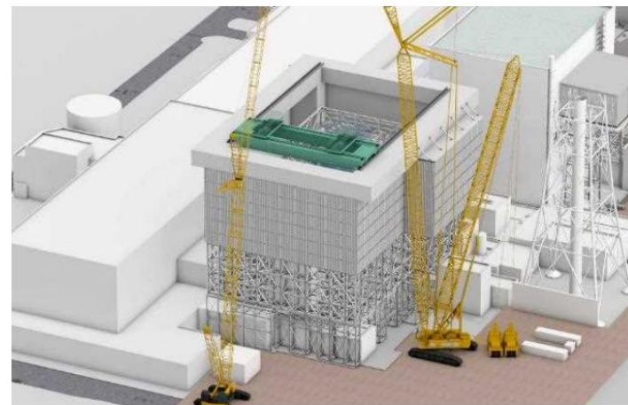
ガレキ撤去用天井クレーン設置完了
