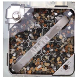
試験前燃料集合体上部 (ダミー燃料)
