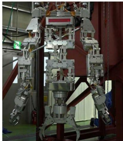
3号機タービン建屋で適用する 柔構造アーム(筋肉ロボット)
