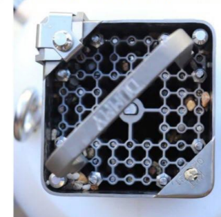
試験後燃料集合体上部 (ダミー燃料)
