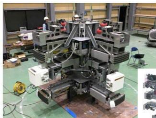
筒身解体装置 組立状況
