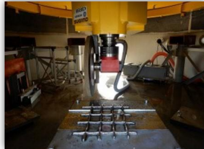
(砥石を使った模擬燃料デブリ凸部の研削試験)
