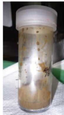
1号機格納容器底部堆積物
