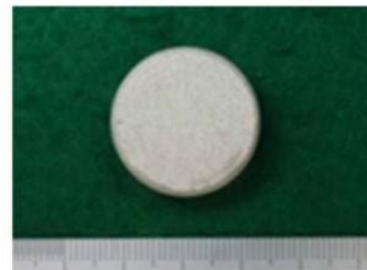
水ガラス/Gd 2 O 3 造粒粉材(硬化後)
