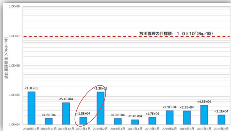
1-6号原子炉建屋からの放出量評価、2019年9月までの評価方法で、その直近12か月分
