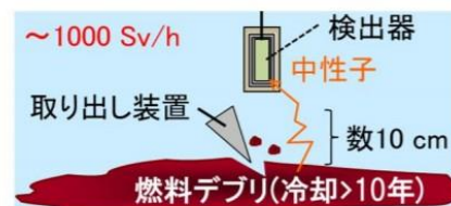
図1 未臨界度測定・臨界近接監視システム概要
