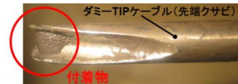
2号機 T I P 配管内閉塞物
