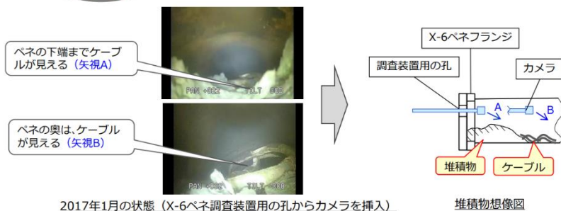
2017年1月の状態 (X-6ペネ調査装置用の孔からカメラを挿入)
