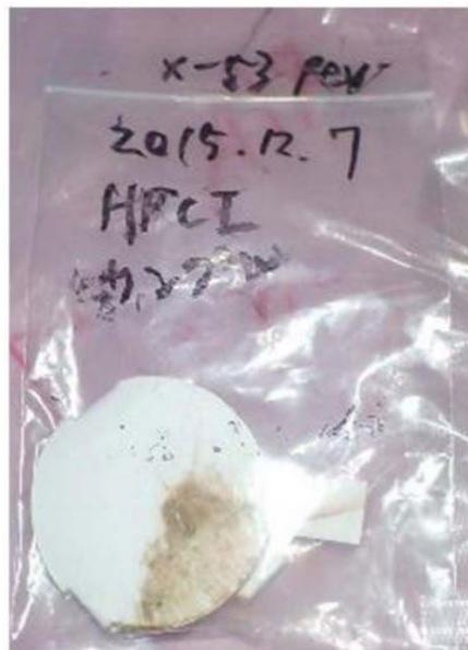
1号機R/B内調査時に格納容器貫通部下部床面、貫通部より採取されたサンプル
