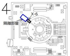
2号機原子炉建屋1階 ペネ配置図
