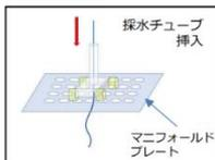
採水用チューブを熱交換器内の細管隙間を通すため、使える孔に制限がある
