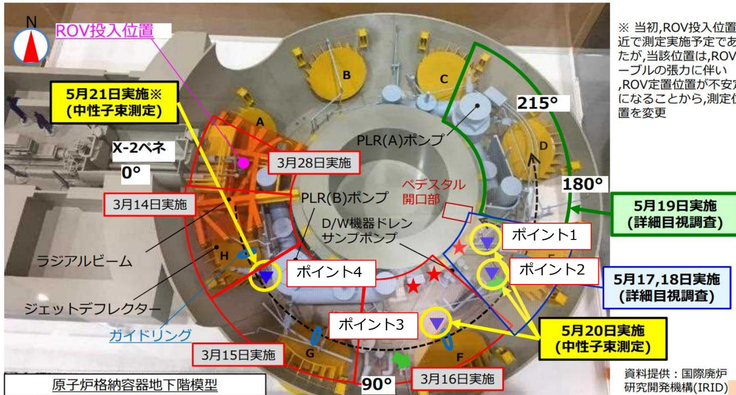
※ 当初,ROV投入位置付近で測定実施予定であったが,当該位置は,ROVケーブルの張力に伴い,ROV定置位置が不安定になることから,測定位置を変更
