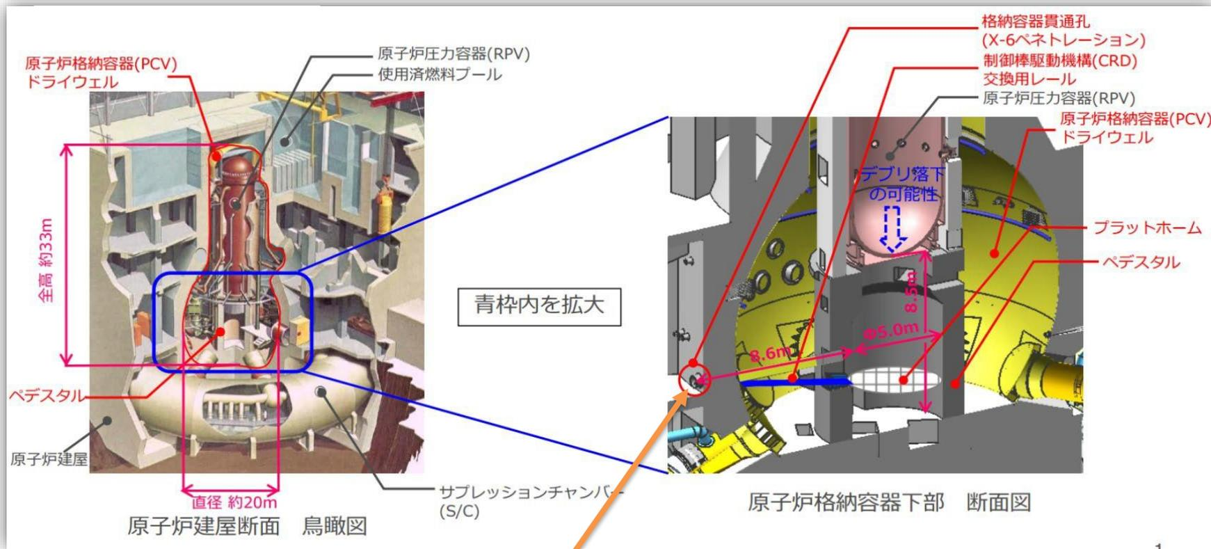
2015年6月、2号機格納容器内部を調査する(A-2調査)ための準備として、この部分(X-6貫通部)の前にあるブロックを除去したところ、予想していなかった高い線量が計測され、東京電力は2016年1月、現在の技術による除染によっては調査装置を投入できる水準の線量にまで下げることができないと判断しました。
