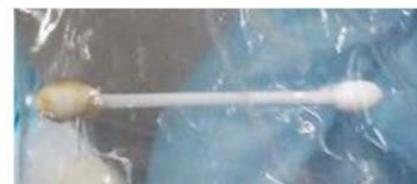
3号機PCV内部調査の一環として使用した、水中ROVへの付着物
