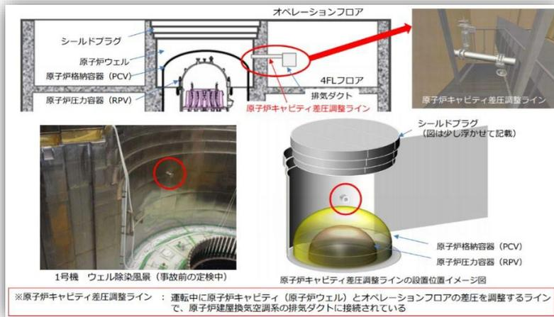
※原子炉キャビティ差圧調整ライン：運転中に原子炉キャビティ（原子炉ウェル）とオペレーションフロアの差圧を調整するラインで、原子炉建屋換気空調系の排気ダクトに接続されている
