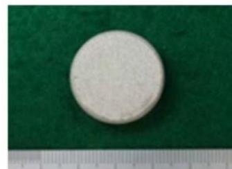
水ガラス/Gd<sub>2</sub>O<sub>3</sub>造粒粉材(硬化後)
