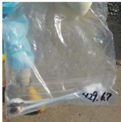
2号機PCV内部調査の一環として使用した、堆積物除去装置への付着物
