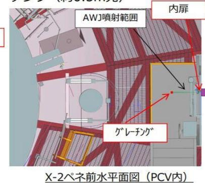
■ 今後のデータ拡充作業No.3 切削範囲：横5°／貫通先の対象：ペDESTAL壁面 (約5m先)
