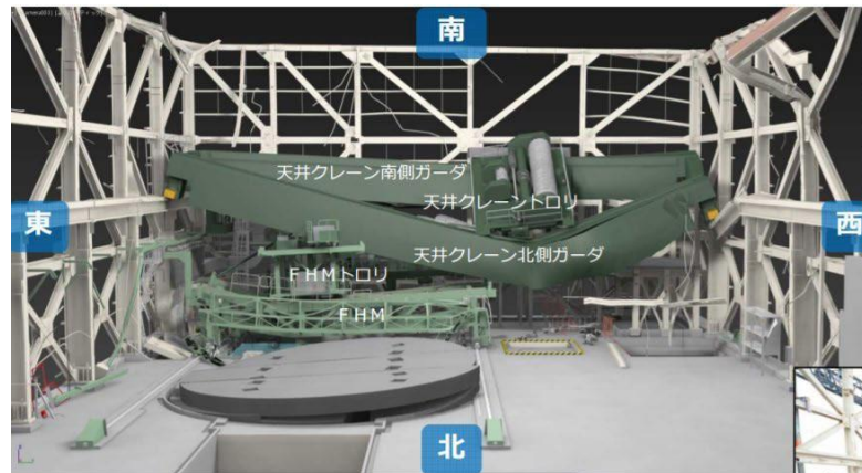
天井クレーン・FHMのイメージ図
