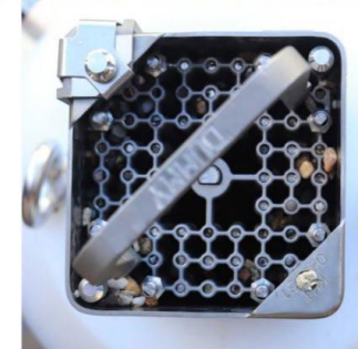
試験後燃料集合体上部 (ダミー燃料)
