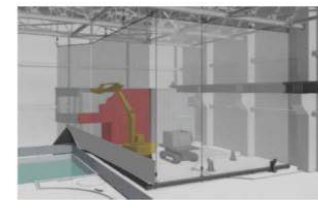
④干渉物撤去 (FHM操作室撤去) ※3 ※3 撤去工法と養生方法は検討中
