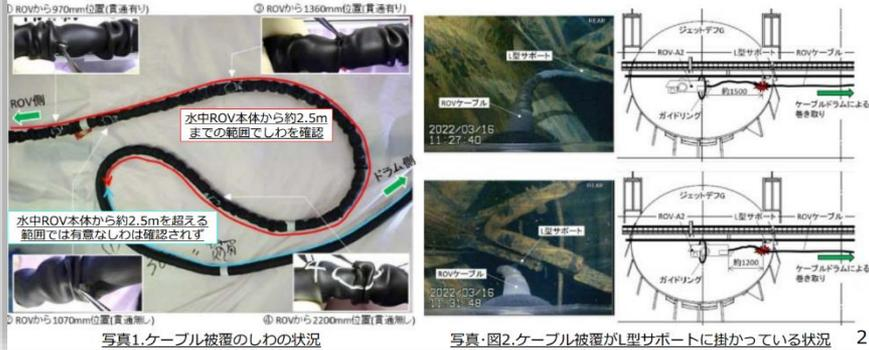
写真・図2.ケーブル被覆がL型サポートに掛かっている状況
