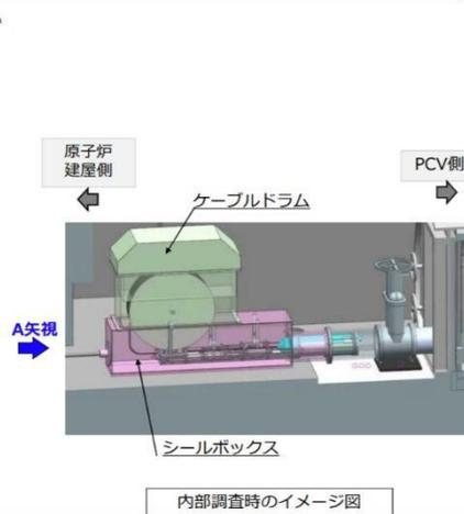
手動ドラム (インストール装置カメラ・水圧チューブ用) 操作用ポール シールボックス
