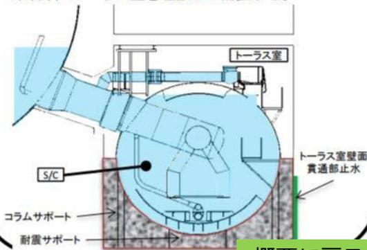
**⑥PCV接続配管バウンダリ構築**
