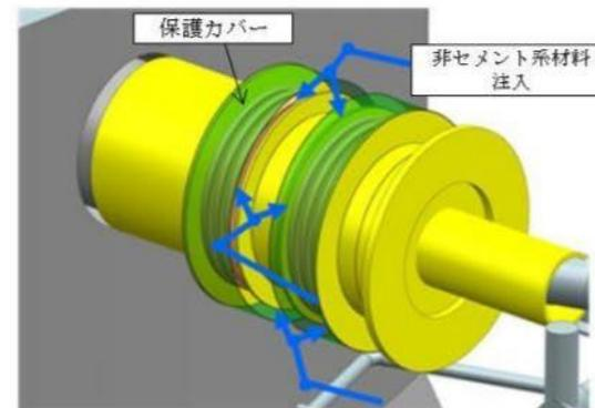
**③-1 ベント管止水技術、③-2 真空破壊ライン止水技術**
