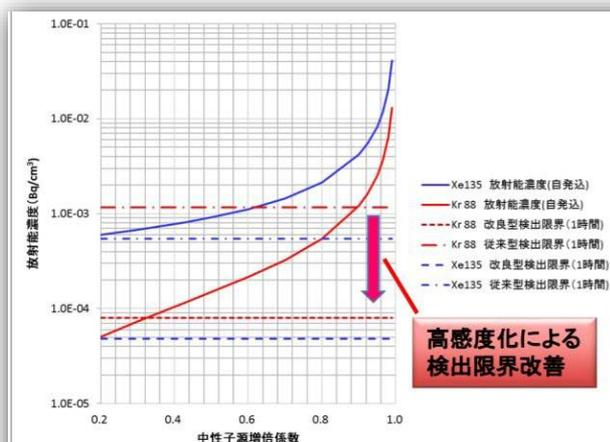
図1 1号機の中性子源増倍率とXe-135, Kr-88濃度の推定値(現状流量、気相体積3600m<sup>3</sup>)
