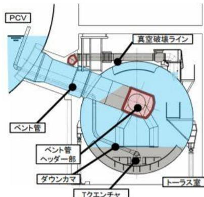
**①S/C脚部補強、⑦トラス室壁面貫通部止水**
