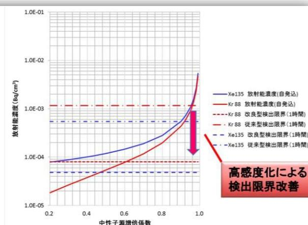
図2 1号機の中性子源増倍率とXe-135, Kr-88濃度の推定値(流量2100m<sup>3</sup>/h、気相体積3600m<sup>3</sup>)
