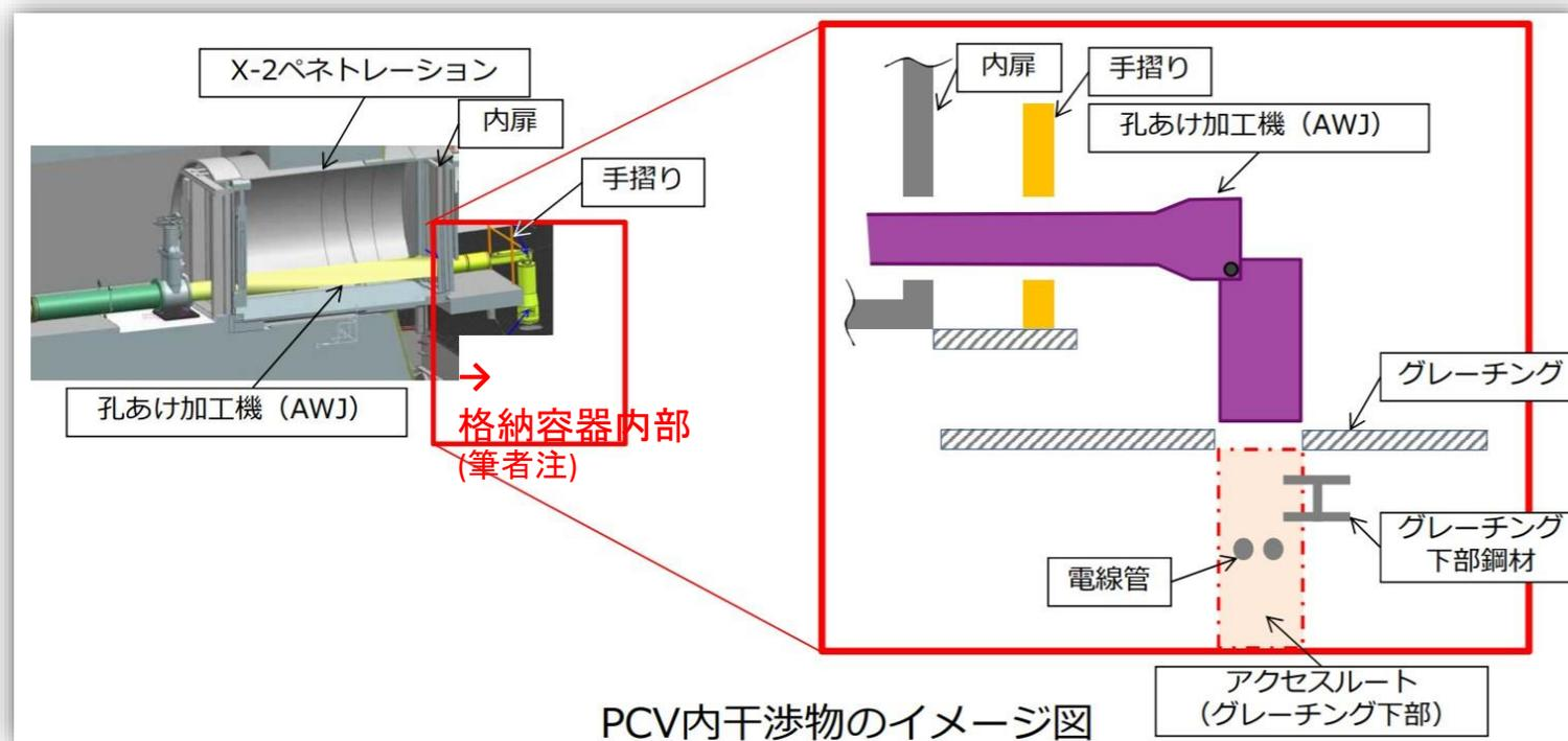
東京電力によると、2020年3月12日の2箇所目となる孔(孔径約0.25 m)の切削の完了に引き続き、4月22日に内扉の3箇所目となる孔(孔径約0.33m)の切削が完了したそうです。
