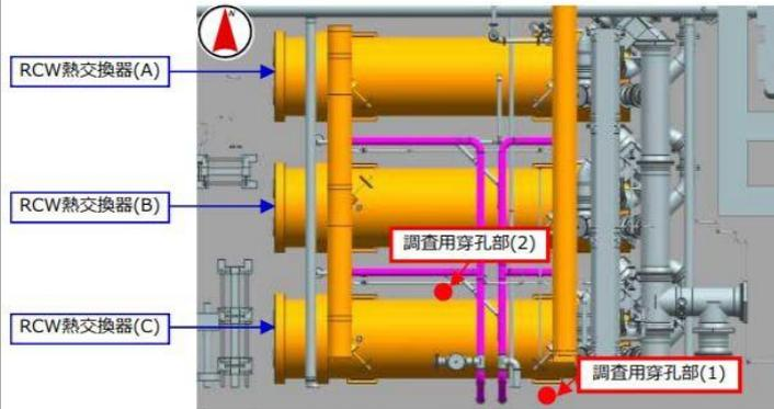
線量測定位置(3階からみた2階平面図)
