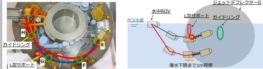
図2.垂直方向での回避対策（イメージ図）
