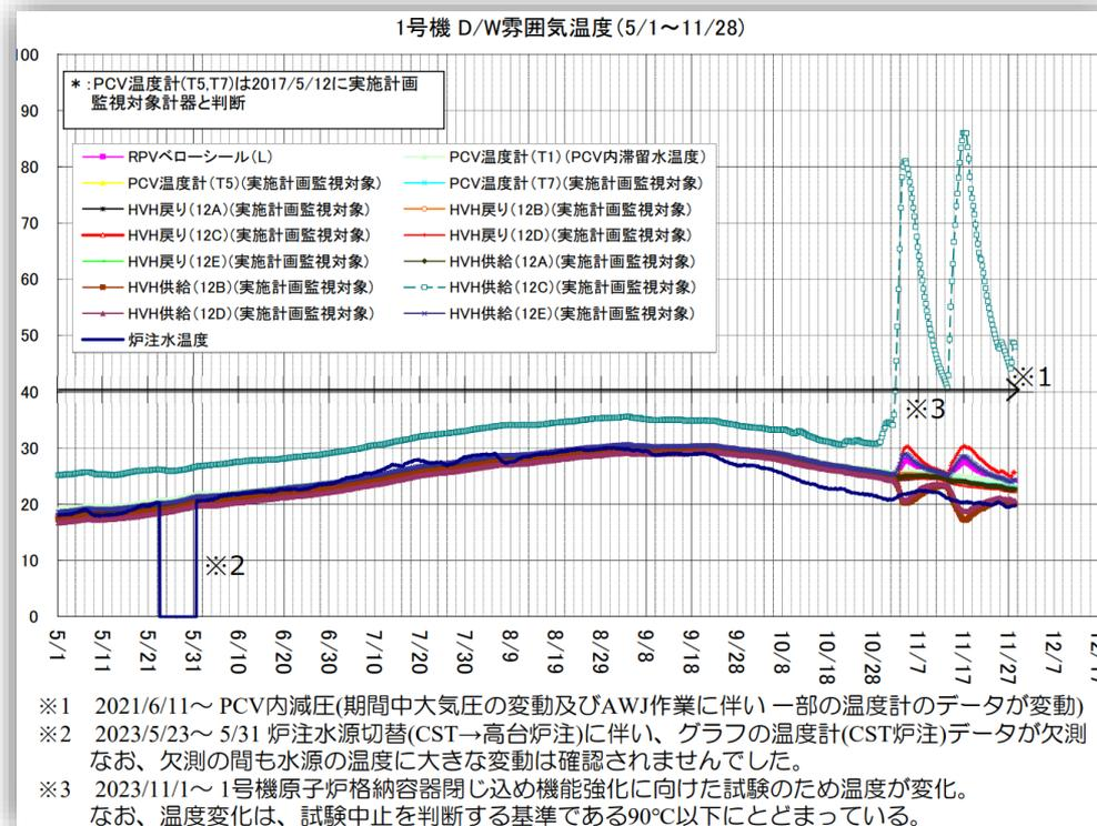
HVH-12C給気ライン(TE-1625H)という温度計の指示値(緑色)が窒素封入量の低減によって90℃近くまで大きく上昇していることが分かります。この上昇が試験中止判断基準に達する見込みとなったため本試験は計画より早期に終了しています。東京電力はこの温度の上昇について、
