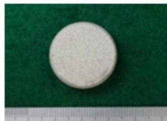
水ガラス/Gd<sub>2</sub>O<sub>3</sub>造粒粉材(硬化後)
