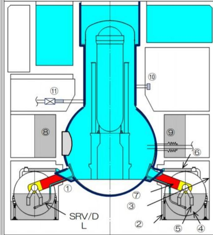
図 燃料取出しのためのPCV冠水範囲構成
