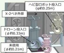
ヘビ型ロボット投入口(φ約0.25m)
