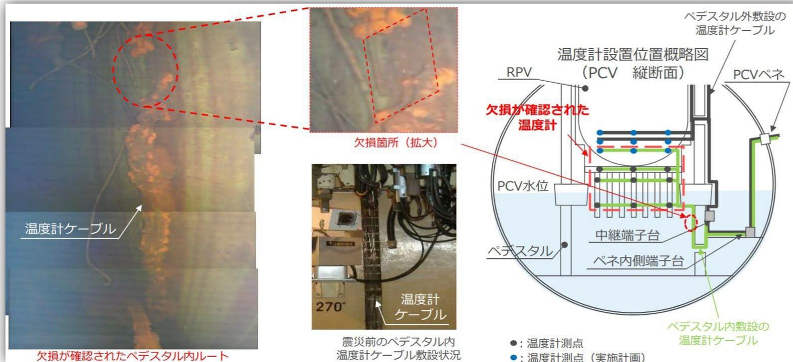
3号機の原子炉圧力容器(RPV)底部にある温度計は、ペDESTAL内ルート12本、ペDESTAL外ルート6本があります。このうち原子力規制委員会に承認されている「福島第一原子力発電所 特定原子力施設に係る実施計画」において定めている運転上の制限の監視に使用している温度計は、ペDESTAL内ルート3本およびペDESTAL外ルート6本です。
