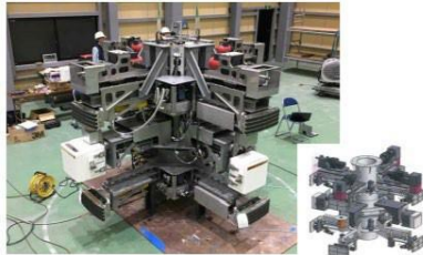
筒身解体装置 組立状況
