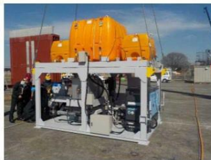
飛散防止剤散布装置
