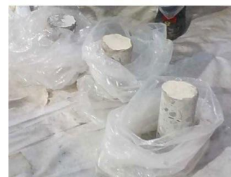
調査用コア採取状況
