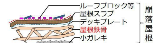
図2 崩落屋根の状態
