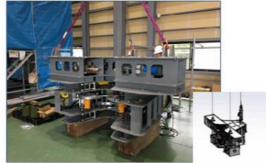
鉄塔解体装置（支柱材用）組立状況
