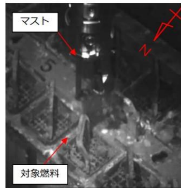
マストと配管の干渉により 吊ることができない燃料 (No.⑭※)
