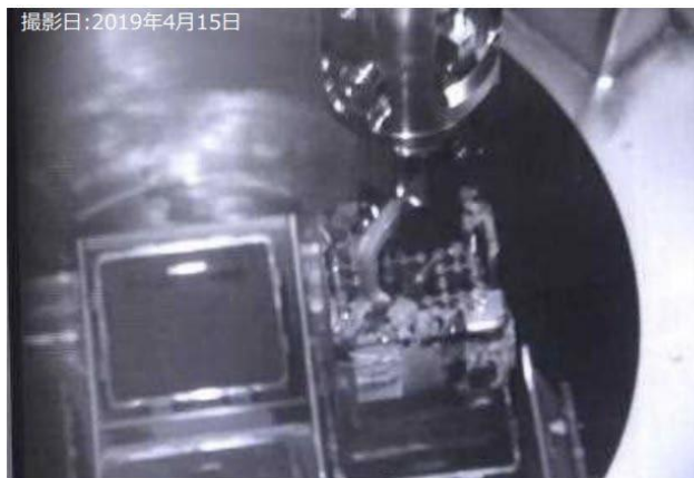
輸送容器へ燃料装填(1体目)
