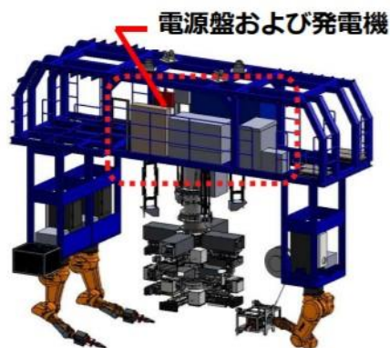
筒身解体装置 外観
