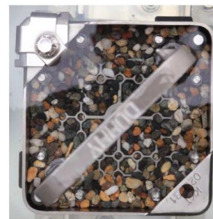
試験前燃料集合体上部 (ダミー燃料)
