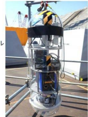
【測定部分】 線量計 CdZnTe半導体検出器
