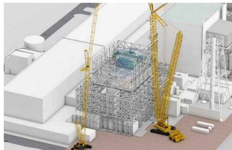
下部架構設置完了
