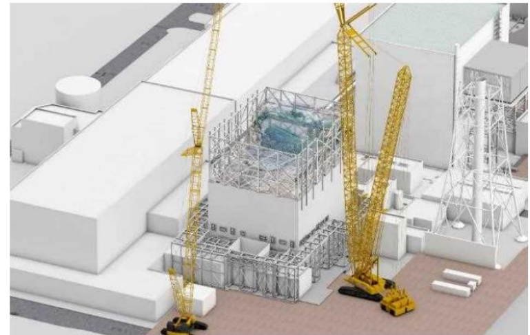
仮設構台設置完了
