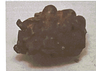
<燃料デブリサンプルの外観（約9mm×約7mm）>
