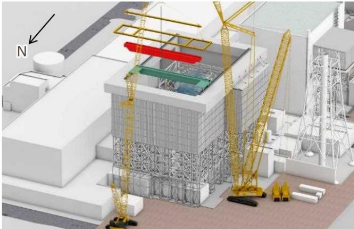
ガレキ撤去用天井クレーン設置中
