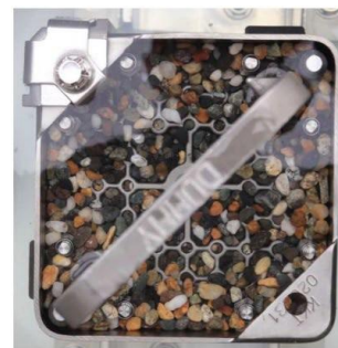
試験前燃料集合体上部 (ダミー燃料)
