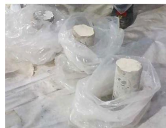
調査用コア採取状況
