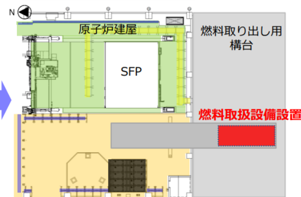
ステップ③燃料取扱設備設置
