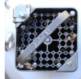
試験後燃料集合体上部 (ダミー燃料)
