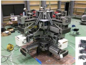
筒身解体装置 組立状況
