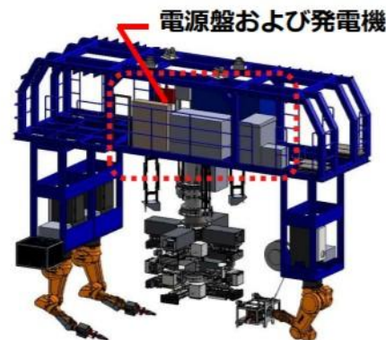
筒身解体装置 外観
