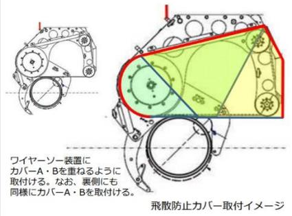
ワイヤソー装置にカバーA・Bを重ねるように取付ける。なお、裏側にも同様にカバーA・Bを取付ける。
