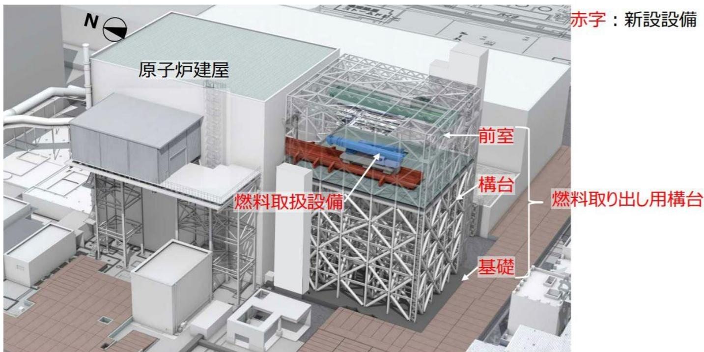
燃料取り出し用構台概念図（鳥瞰図）
