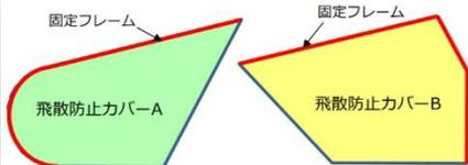
・飛散防止カバーA・Bは防災シートにテフロン処理をしたもの。固定フレーム部でシートは固定されており、固定フレーム部以外は自由端。
