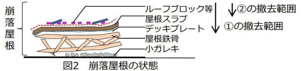
図2 崩落屋根の状態
