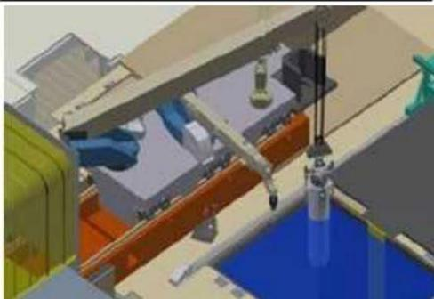
⑤燃料取扱機で燃料を構内輸送容器へ移動
