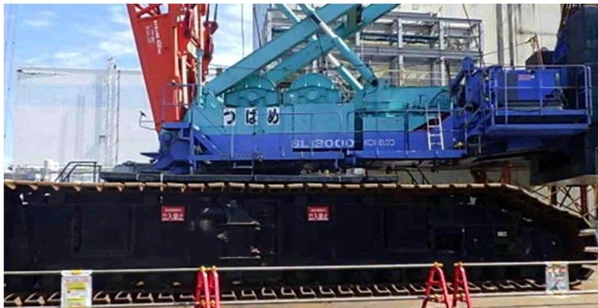
しかし、11月3日の準備作業中に、撤去に使用するクローラークレーンの1台(左引用写真)が異音を発し、3台中2台の減速機にシャフトの揺れ、ベアリングの錆が確認され準備作業は中断していました。
