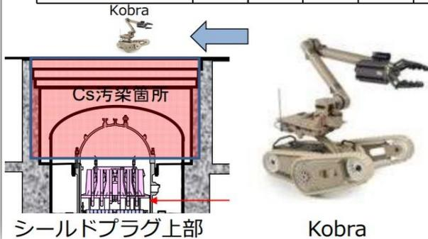
Kobraに線量計を搭載し、遠距離、近距離に存在するCsからのγ線とβ線の線量の関係からシールドプラグ下面に付着するCs量を評価する。
