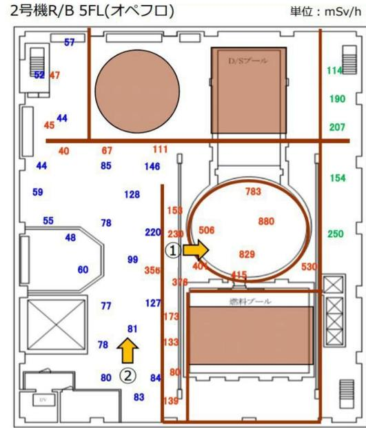
出典：2019年1月31日 第62回廃炉・汚染水対策チーム会合／事務局会議資料 東京電力「2号機原子炉建屋オペフロ残置片付後調査進捗について」
