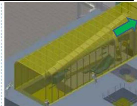
④構内輸送容器取扱クレーンで構内輸送容器をキャスクピットへ移動
