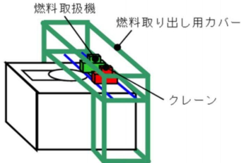
図3 3号機の燃料取扱設備等（イメージ図）
