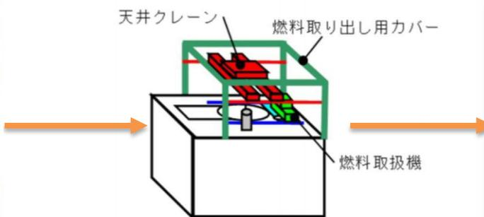
図1 1号機の燃料取扱設備等(イメージ図)
