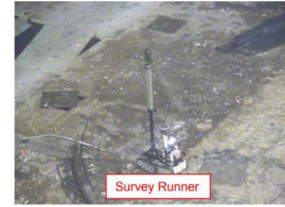
③3Dスキャンによる寸法形状測定状況
