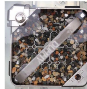
試験前燃料集合体上部 （ダミー燃料）
