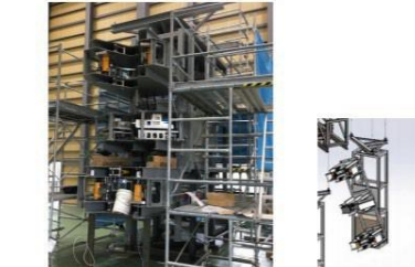
鉄塔解体装置（斜材用）組立状況
