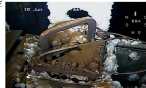
ワイヤー修復燃料上部の様子
