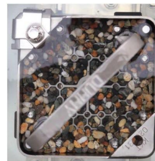
試験前燃料集合体上部 (ダミー燃料)
