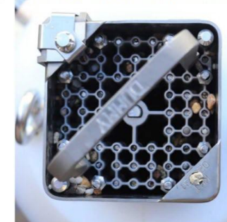
試験後燃料集合体上部 (ダミー燃料)
