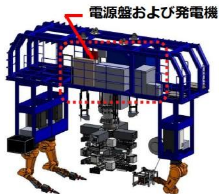
筒身解体装置 外観
