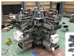
筒身解体装置 組立状況
