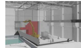
④干渉物撤去 (FHM操作室撤去) ※3
