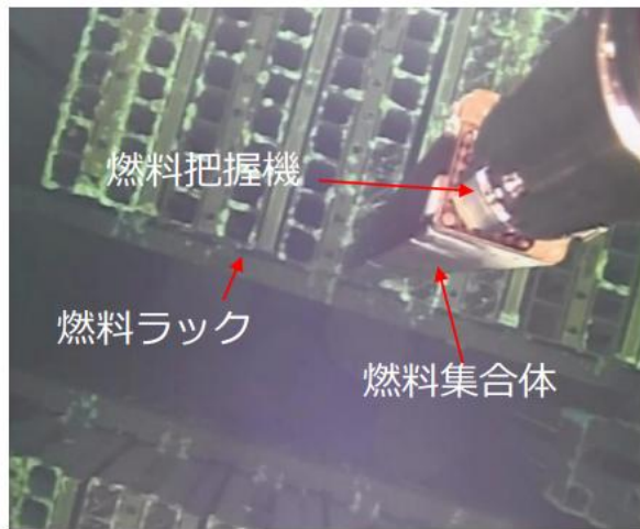
1体目の燃料をラックから持ち上げ始める様子 (6月2日午後0時ごろ)
