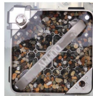
試験前燃料集合体上部 （ダミー燃料）
