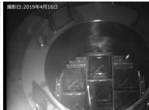
輸送容器へ燃料装填完了(7体)
