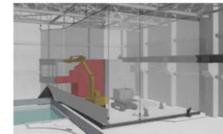
④干渉物撤去(FHM操作室撤去) ※3
