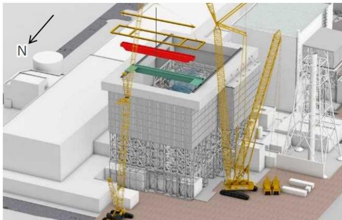
ガレキ撤去用天井クレーン設置中
