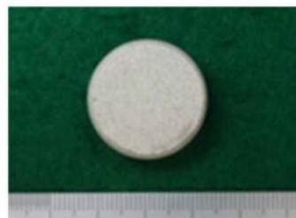
水ガラス/Gd 2 O 3 造粒粉材(硬化後)
