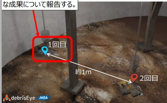
図 2号機ペDESTAL内床面 燃料デブリの採取位置
