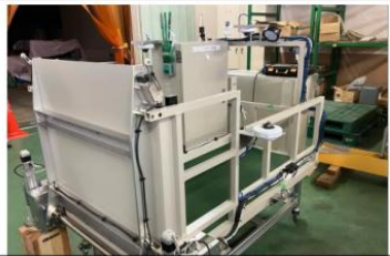
○FirstLook/SPOTを搭載するための架台
