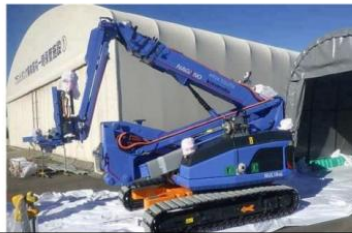
○高所作業台車 γイメージャ/FirstLook/SPOTを 搭載するための架台を設置し、 各階に運搬
