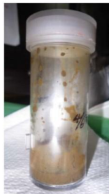
1号機格納容器底部堆積物
