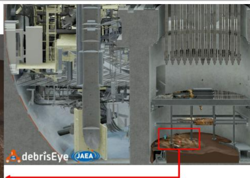
図 2号機ペDESTAL内床面 燃料デブリの採取位置
