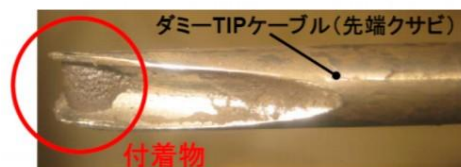
2号機 T I P 配管内閉塞物
