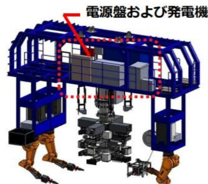
筒身解体装置 外観
