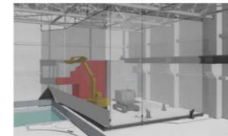
④干渉物撤去(FHM操作室撤去) ※3
