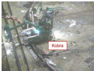
④低所表面汚染測定状況
