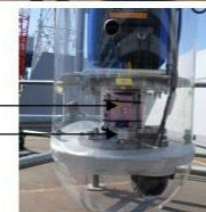
【測定部分】 線量計 CdZnTe半導体 検出器
